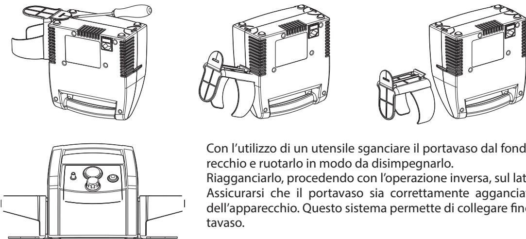
Con l'utilizzo di un utensile sganciare il portavaso dal fondo dell'apparecchio e ruotarlo in modo da disimpegnarlo.
