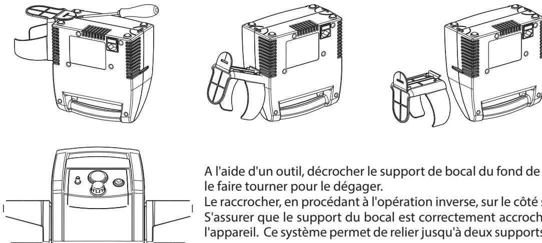
A l'aide d'un outil, décrocher le support de bocal du fond de l'appareil et le faire tourner pour le dégager.
