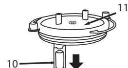
2. Retirer le flotteur (.10a) du dispositif de protection (.10)
