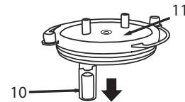
2. Извлеките поплавок (10a) из защитного устройства (10)
