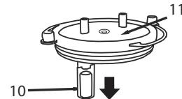
2. Nehmen Sie das Schwimmelement (10a) von der Schutzvorrichtung (10) ab.
