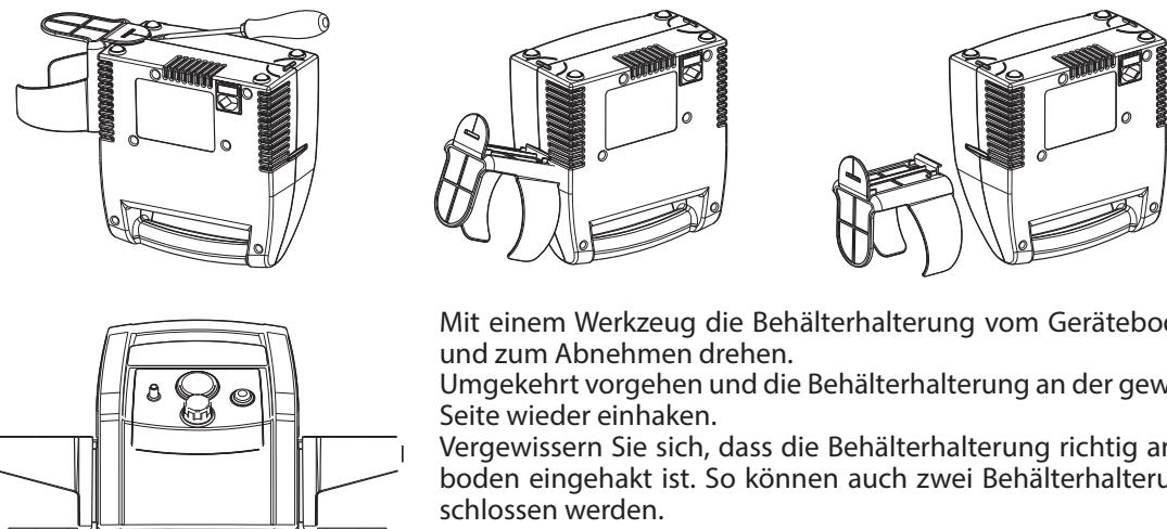
Mit einem Werkzeug die Behälterhalterung vom Geräteboden lösen und zum Abnehmen drehen.
