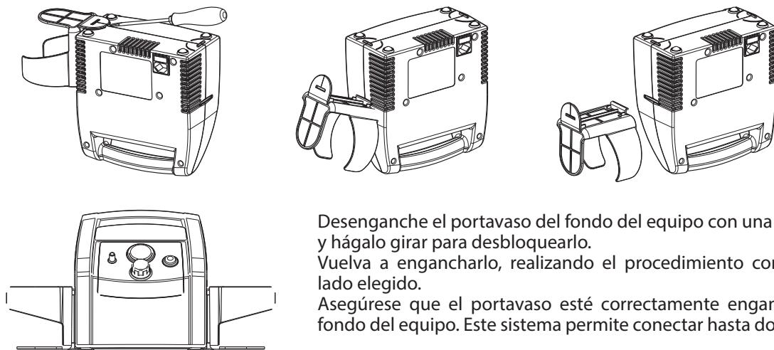
Desenganche el portavaso del fondo del equipo con una herramienta y hágalo girar para desbloquearlo.
